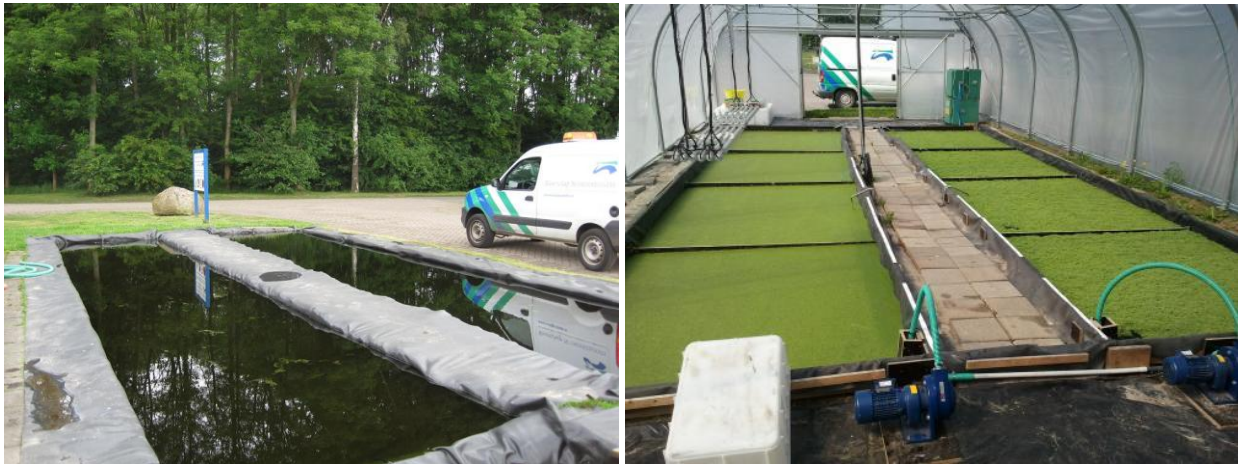
Figuur 2.1. Links: proefsloten direct na aanleg in het voorjaar van 2010. Rechts: de geoptimaliseerde sloten met meetapparatuur en foliekas.
